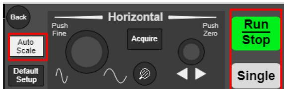
[Run/Stop]キーにより波形の収集が開始、停止されます。緑色点灯時は波形収集実行中、赤色点灯時には停止中です。
