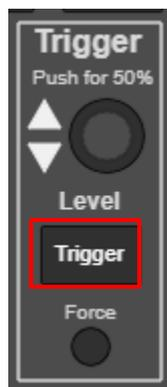
トリガ待ち中にトリガコントロールの[Force]キーで強制的に収集を開始することができます。
