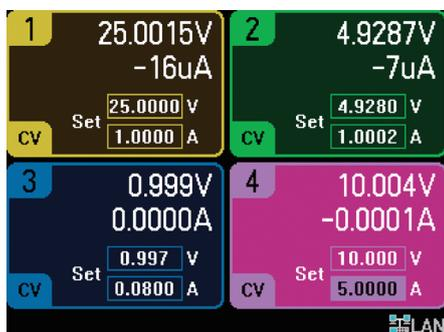
各モジュールは電圧&電流測定機能を内蔵するので、メータービュー機能を使えば最大4チャンネル出力で「設定電圧・電流値」、「実際の電圧・電流値」が同時に表示されます。
