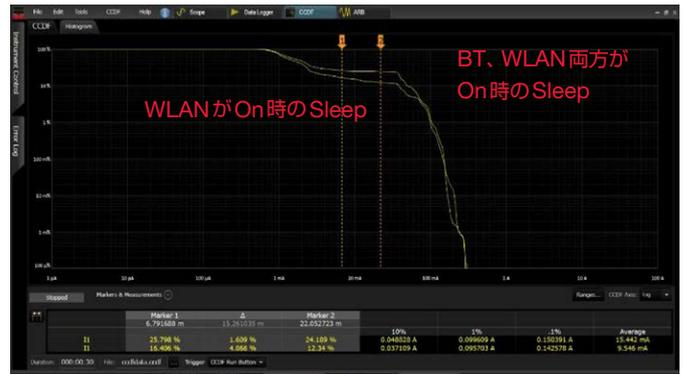
上記測定例：BTをOn/Off 時の波形比較
