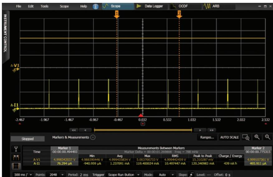
図5：マーカーを使用したオシロスコープでの捕捉
