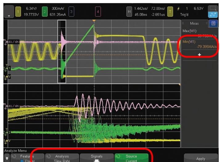
図23: トランジスタのターンオンフェーズの電流波形のスルーレートの測定例
