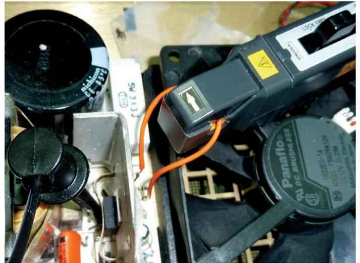
図4： 電流測定用電流ループの作成例
