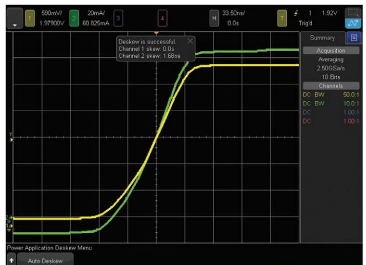
図7: 自動スキュー補正実行後のスキュー補正画面
