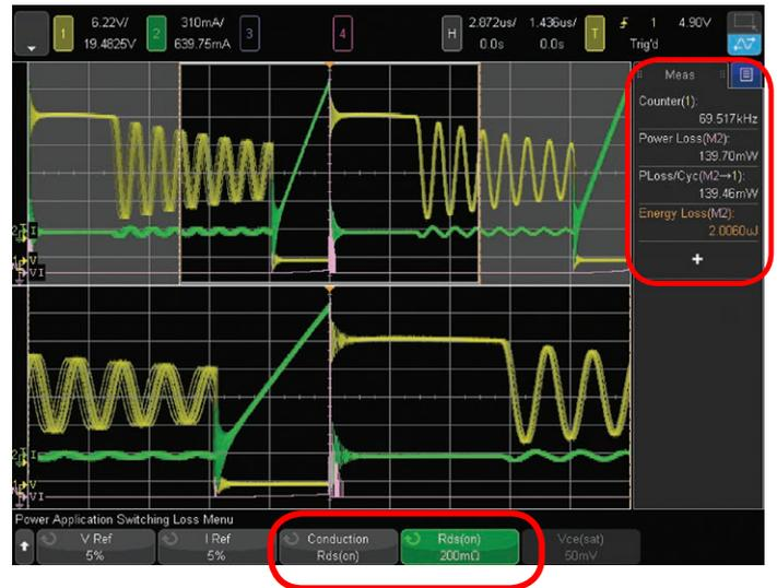
図17: 入力された $R_{ds(on)}$ 値に基づきパワー/エネルギー損失の測定を行った例
