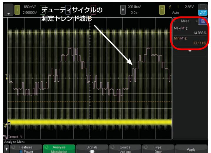
図25: スイッチングトランジスタのゲート入力信号のデューティサイクルの変調測定例
