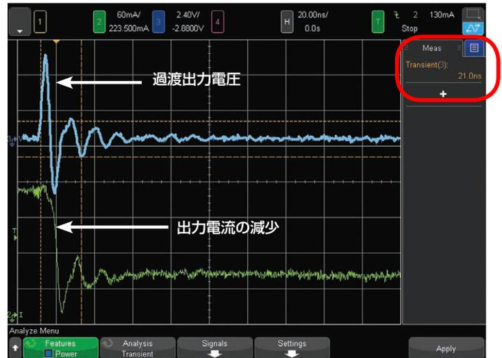
図35： 出力負荷が減少(出力電流が突然減少)したときの過渡応答セトリング時間の測定例
