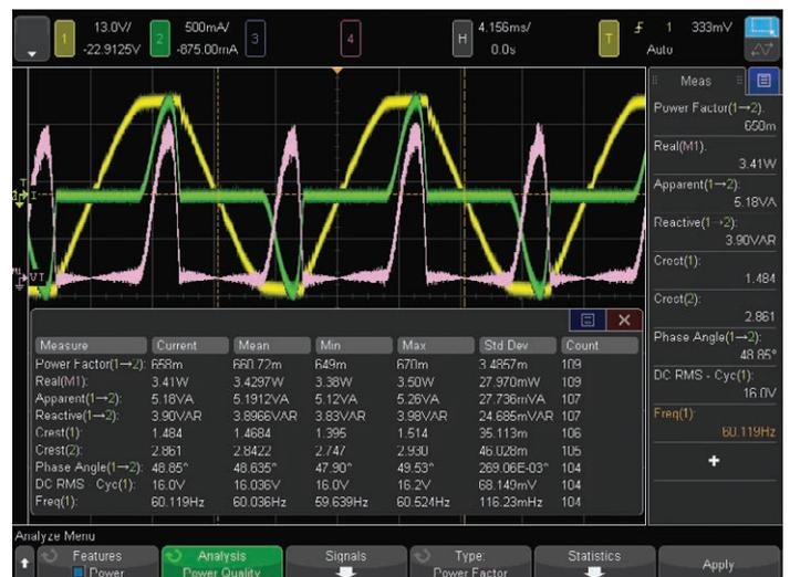
図9: AC電源ライン入力パワー品質の測定例
