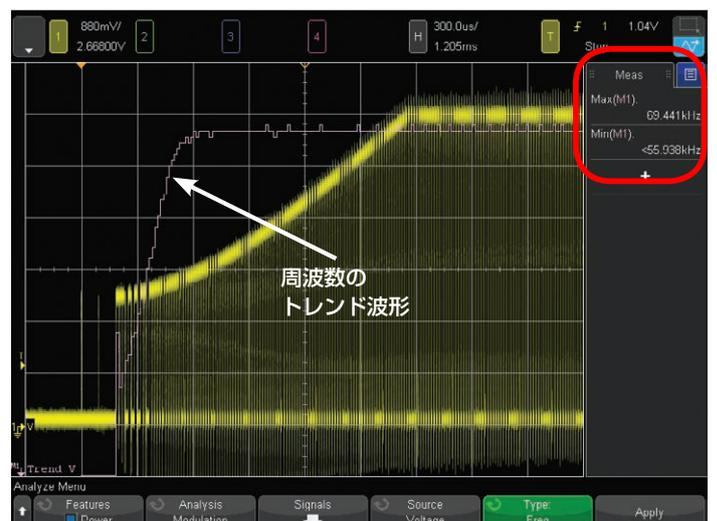
図26: 電源投入時におけるパワートランジスタのゲート入力信号周波数の変調測定例
