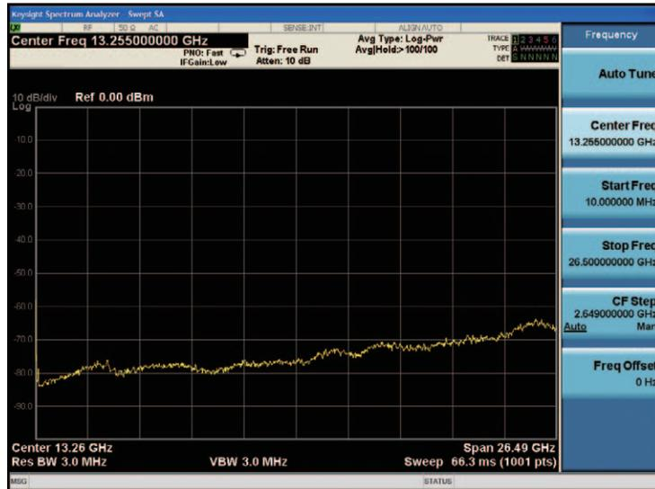
図7-10. ノイズフロアの上昇は、使用するLO高調波の変更に伴う感度の変化を示します
