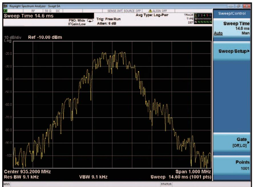
図2-41. GSM信号のスペクトラム
