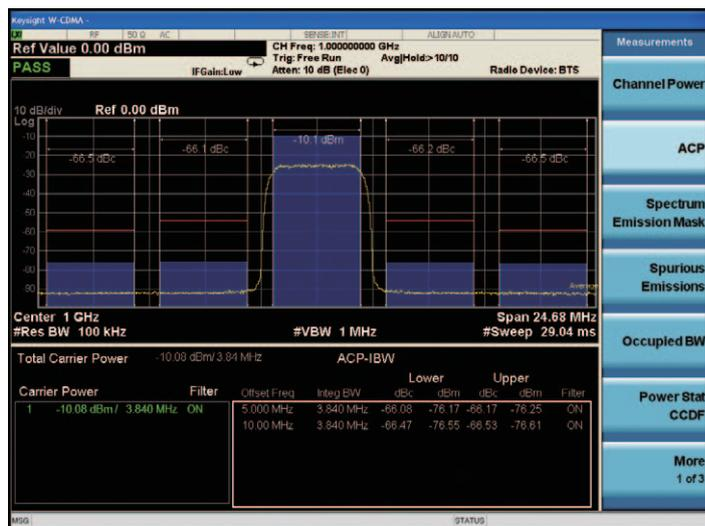
図6-9. PXAスペクトラム・アナライザによる隣接チャンネル電力測定
